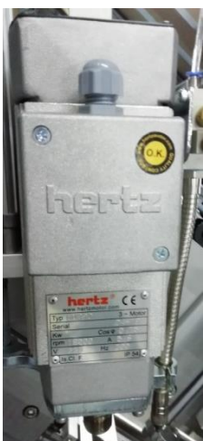
1,1 Kw - 18.000 RPM Hoge frequentie spindel
