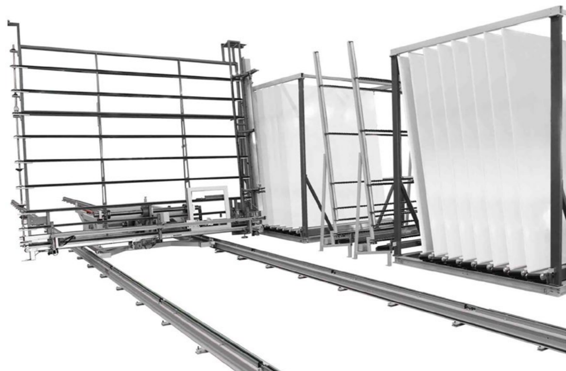
Buffersysteem met volautomatische verdeelwagen Système de stockage avec navette automatique
